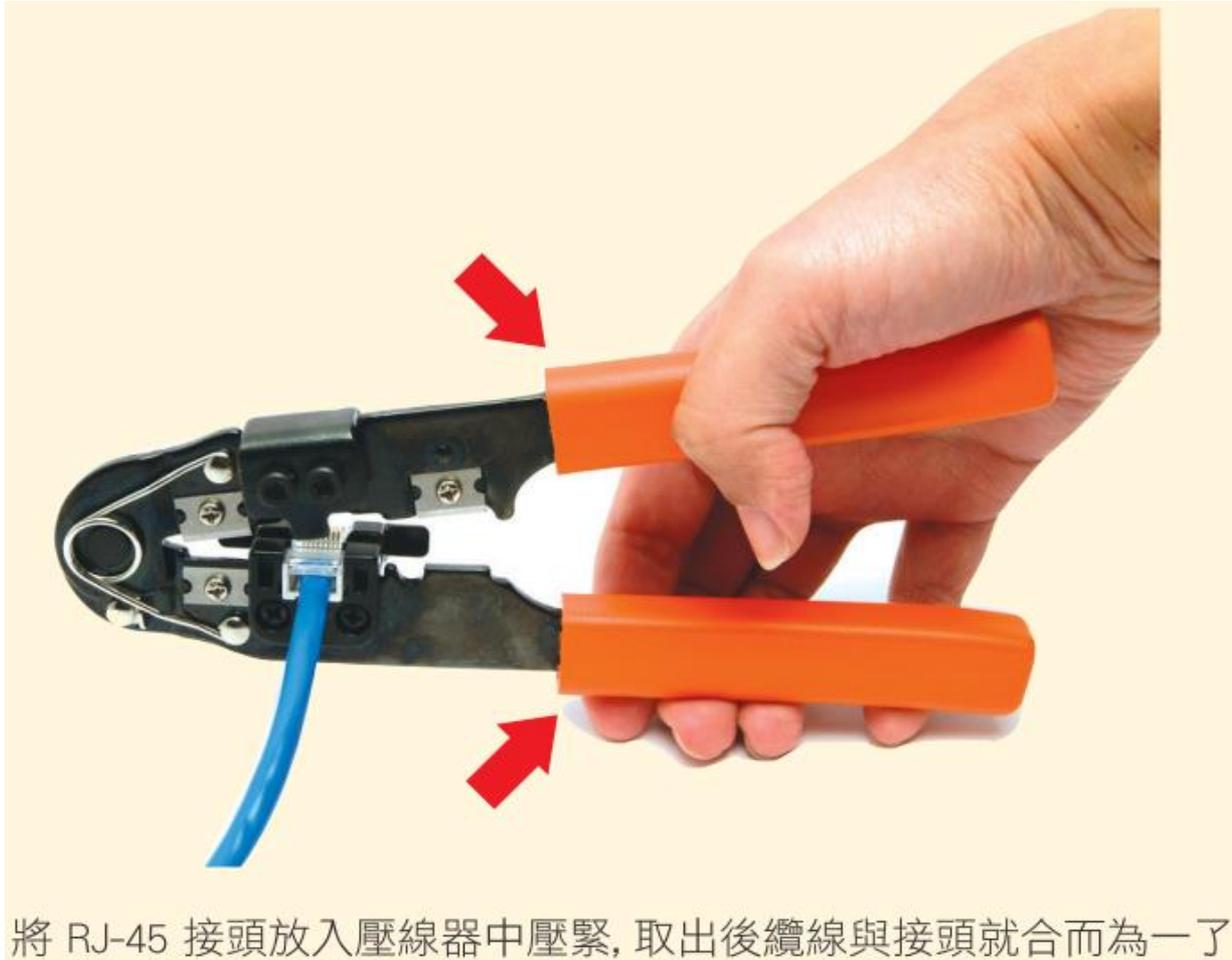
將 RJ-45 接頭放入壓線器中壓緊, 取出後纜線與接頭就合而為一了
