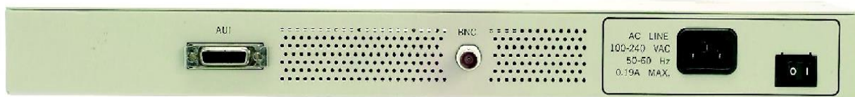
圖 3-32 有些集線器除了 RJ-45 插槽之外, 還具有 BNC 接頭和 AUI 接頭
