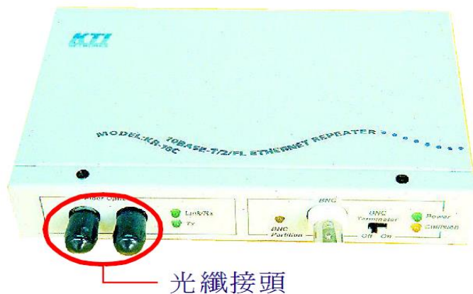
圖 3-28 這部中繼器正面具有光纖和 BNC 接頭
