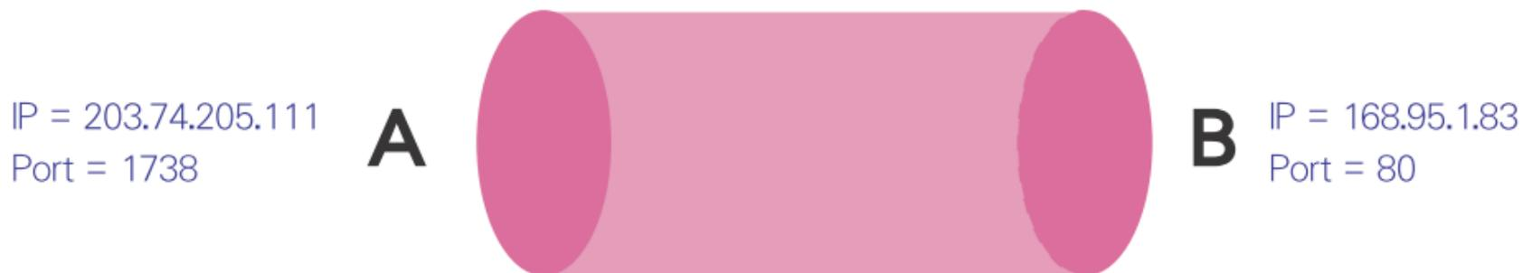
圖 11-19 TCP 連線是由連線兩端的 IP 位址與連接埠編號所定義
