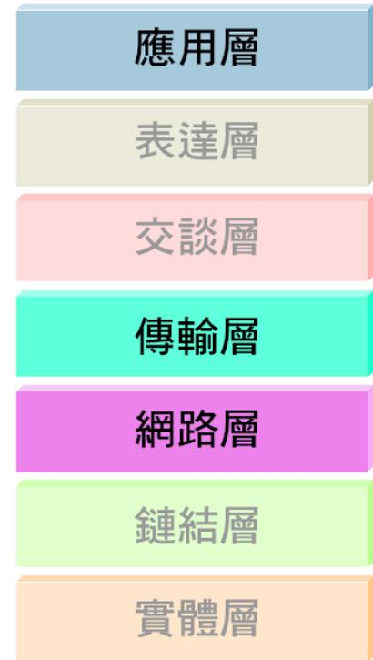
圖 15-19 封包過濾型的防火牆主要在網路層及傳輸層運作；應用層過濾型及代理器防火牆則是在應用層運作
